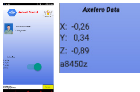
Gambar 4.4. Uji accelerometer pada saat miring ke kanan depan
