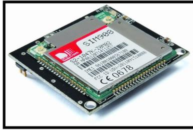
Gambar 6. GSM/GPRS SIMCOM SIM908
